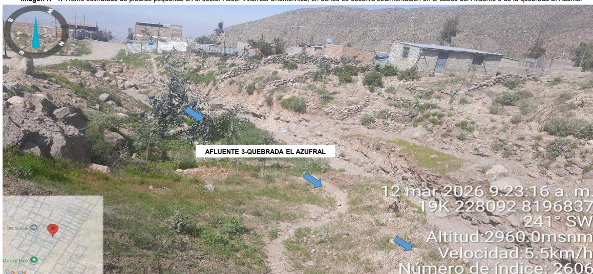
Imagen N° 2. Zona colmatada en el tramo, en donde se observa sedimentación en el cauce del Afluente 3 de la quebrada El Azufral.
