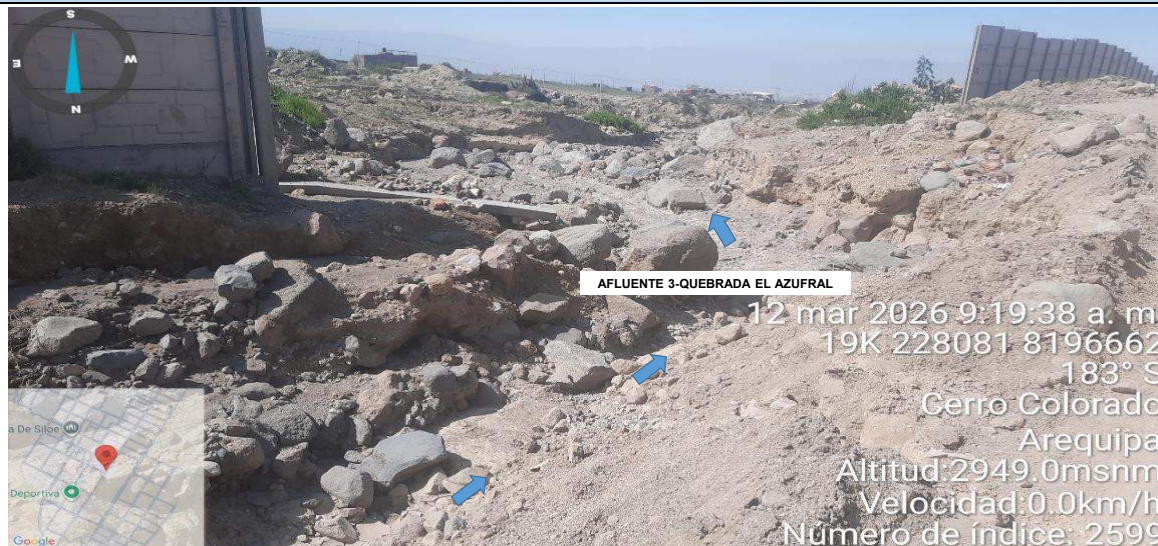
Imagen N° 1. Tramo colmatado de piedras pequeñas en el sector Asoc. Villarreal Chumbivilca, en donde se observa sedimentación en el cauce del Afluente 3 de la quebrada El Azufral.
